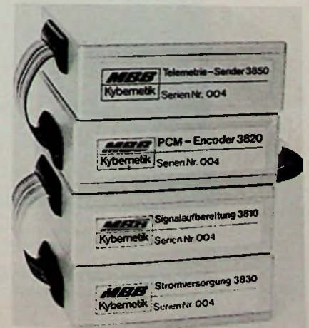
Bild 2. PCM-Telemetriesender für acht Meßwerte (Messerschmitt-Bölkow-Blohm GmbH)
